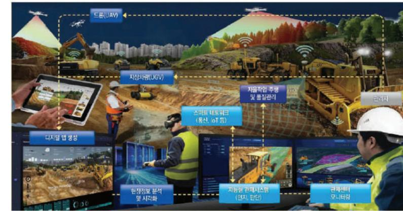
드론 및 지상차량 (UGV)의 자율 계측을 통해 취득한 현장 지형정보를 통합하여 초정밀 Digital Map을 생성하고, 이를 도로 건설장비 자동화 기술(MG, MC, 원격, 무인)과 융합하거나 다양한 건설장비의 실시간 관제에 활용
