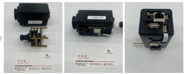
다채널 CCTV 동시 AI 분석을 위한 NPU 기반 AI 연산 시스템
